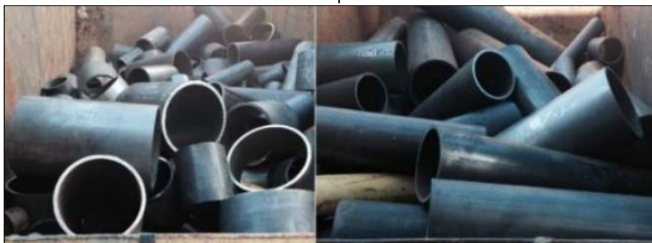
Figura 3 – Contêineres de armazenamento de retalhos de tubos utilizados para fabricação de cilindros telescópicos.
