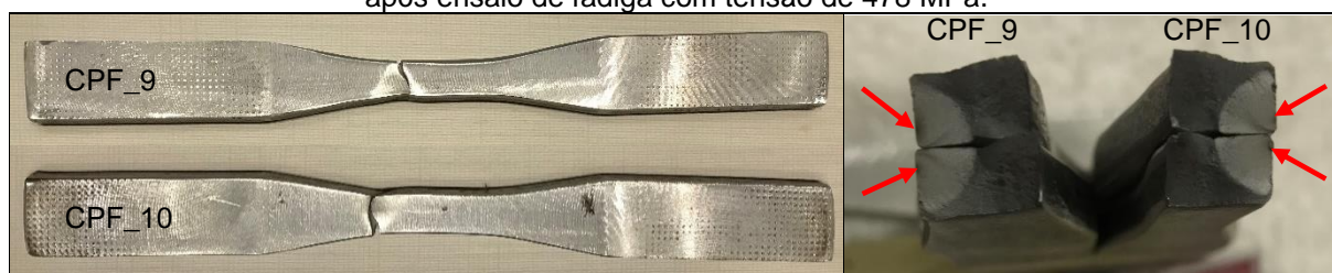
Figura 49 – Corpos de prova obtidos na região da costura original do tubo que apresentaram ruptura após ensaio de fadiga com tensão de 478 MPa.
