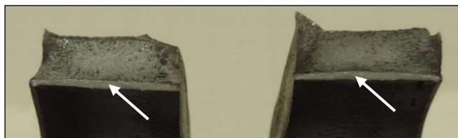
Figura 45 – Fratura do corpo de prova CPT_5, onde as setas indicam a região com falta de fusão e características de fratura com baixa ductilidade.
