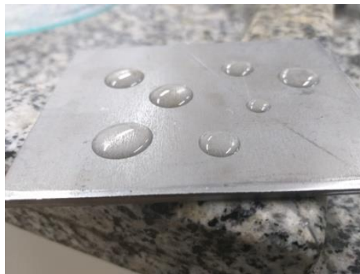
Figura 5: Amostra com gotas d'água antes do desengraxe. Fonte: autor
