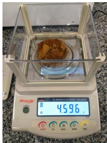
Figura 10: Excesso de cobre pesado em balança de precisão.
