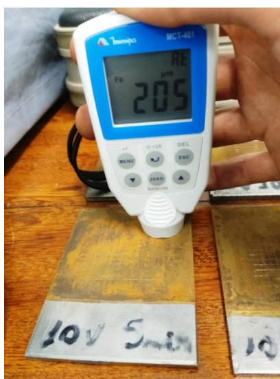
Figura 14: medição de espessura Fonte: autor
