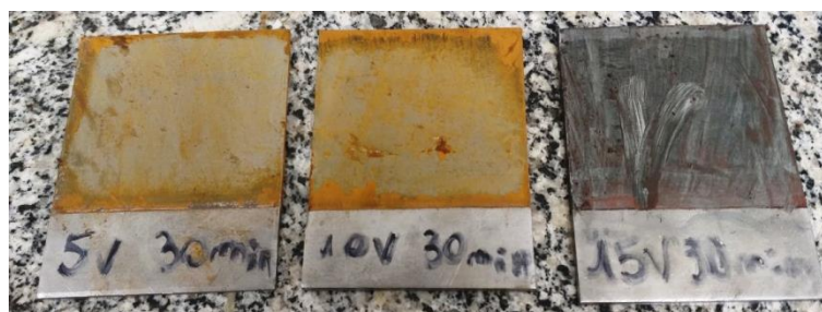
Figura 8: Amostras de 30min após raspagem do excesso de cobre.
