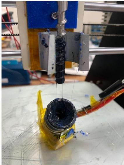
**Figura 21. Entupimento e dificuldade de escoamento.**
