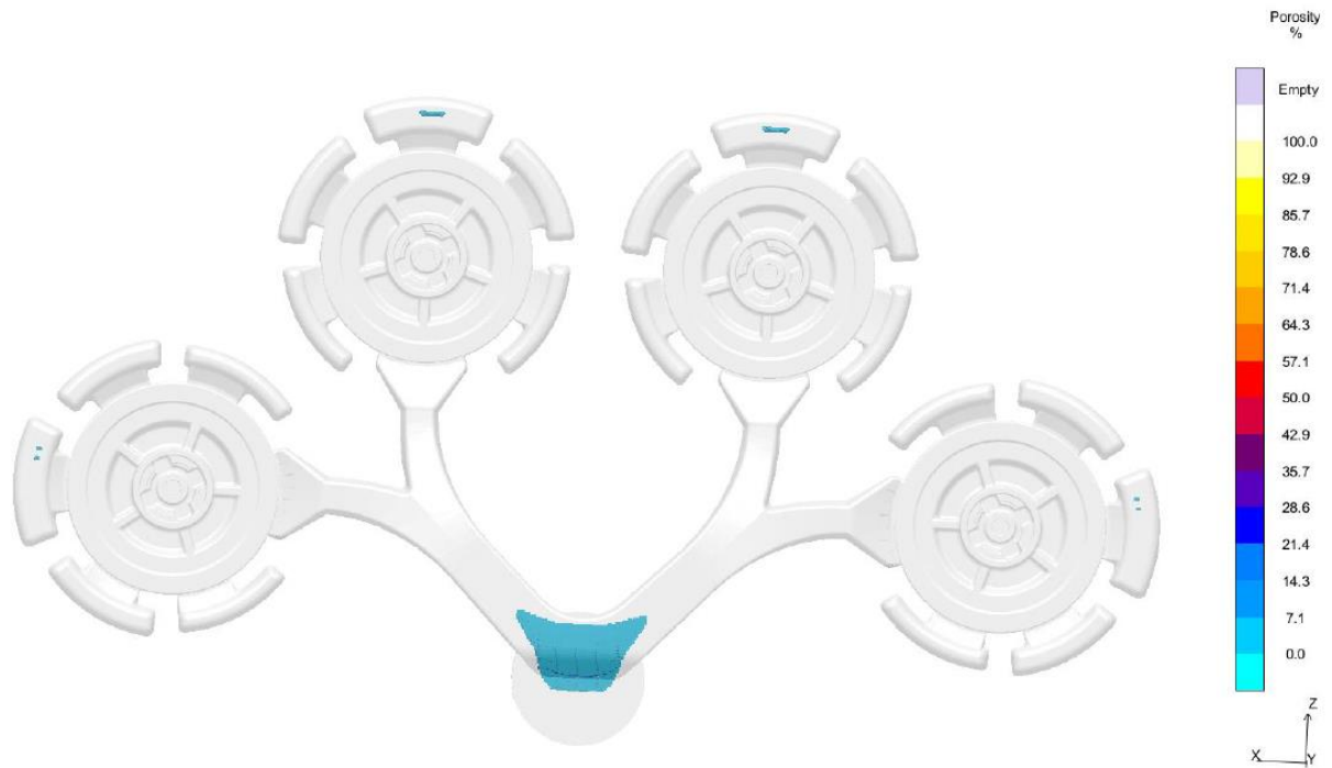
Figura 14. Porosidade por contração volumétrica na versão 02.
