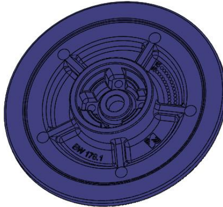
Figura 1. Polia de alumínio fundido. Desenhado no software Solid Works.
