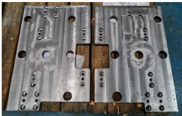
Figura 49 - Chapas base do conjunto fixo com regulagem de posição
