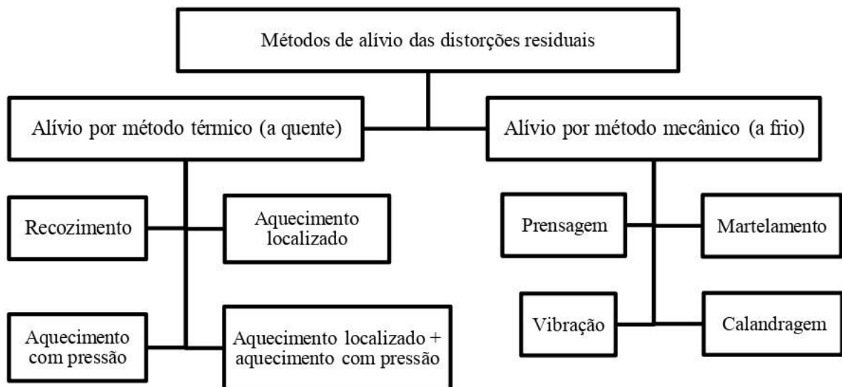
Figura 2 - Fluxograma dos métodos de alívio de distorções residuais
