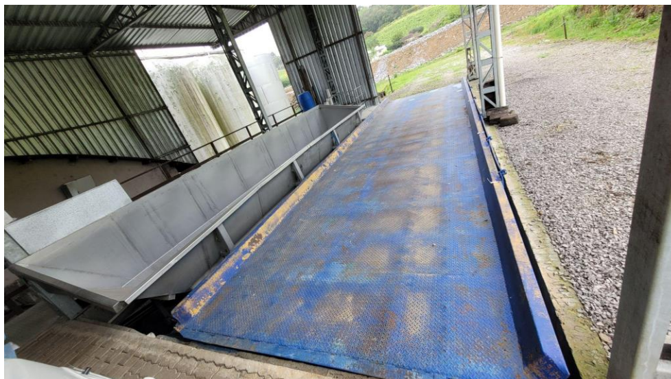
Figura 3: Balança e lagar para recebimento de uvas
