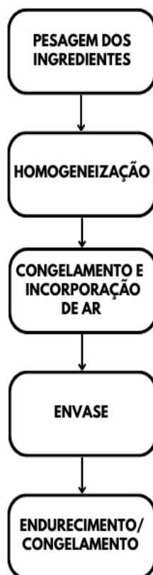
Figura 4: Fluxograma de processamento do sorvete italiano.
