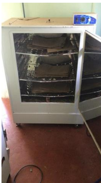
Figura 12: Estufa de circulação de ar forçada.
