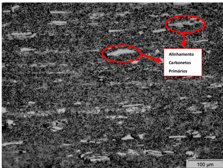
Figura 24 - Micrografia das amostras como recebidas, direção transversal ataque Nital 2%, onde é possível observar os carbonetos primários distribuídos na matriz coalescida.
