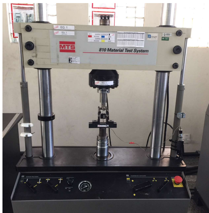
Figura 23 - Equipamento para o ensaio de tenacidade à fratura geometria SE(B).
