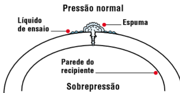
Figura 15 - Teste de estanqueidade.
