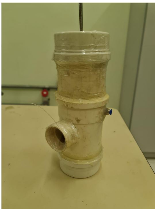
Figura 25 - Montagem do corpo do robô, com cabo para amarração da câmera.
