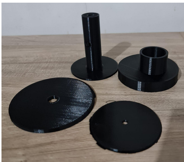
Figura 21 - Carretel e suporte feito por meio de impressora 3D.
