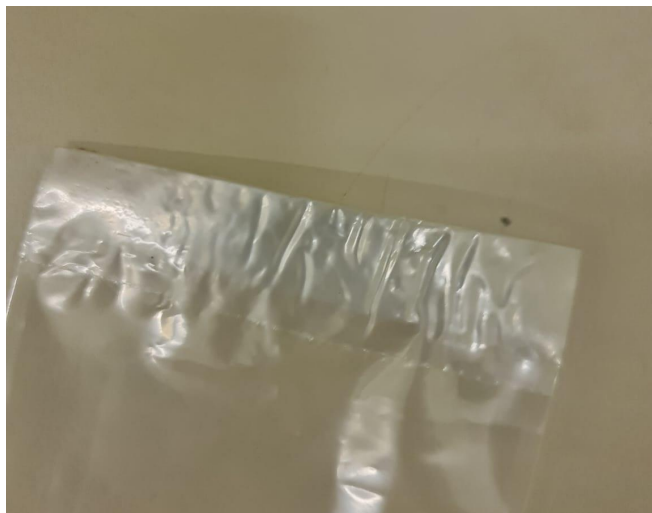
Figura 22 - Solda do tubo flexível.
