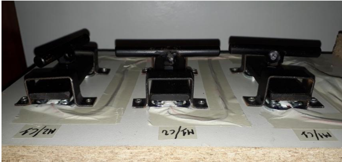
Figura 6. Sistema de morsas projetado para a aplicação controlada de pressões sobre os sensores de carga.
