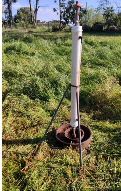
Figura 4: Método do infiltrômetro de anéis concêntricos.
