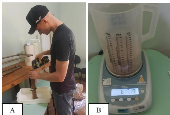
Figura 18 – Realização da determinação do peso do hectolitro (A), pesagem da amostra para conversão em peso do hectolitro (B).
