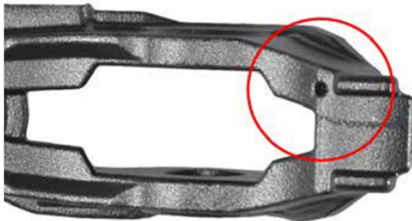
Figura 13 - Defeito causado por bolha de gás
