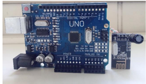
Figura 8 – Placa Arduino Uno e módulo de comunicação sem fio NRF24L01. Do autor.
