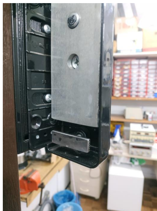
Fig. 14: Alocação da chapa que fecha o contato do sistema
