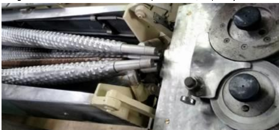
Figura 05: Saída de uma bastonadeira para a trefila, na produção de balas.
