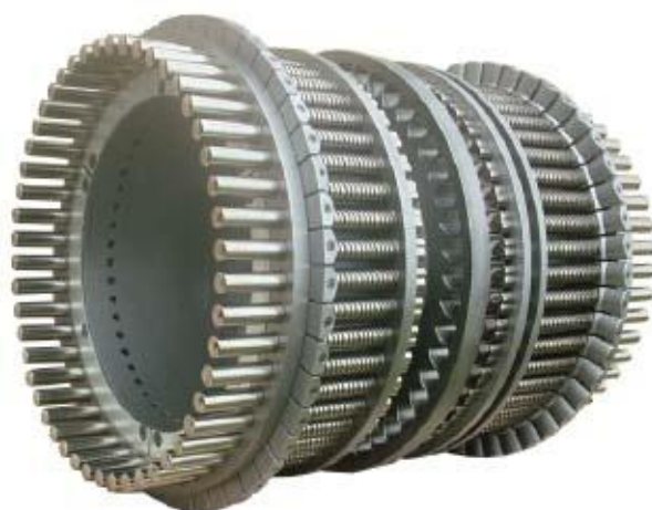
Figura 06: Estampo utilizado na produção de balas.
