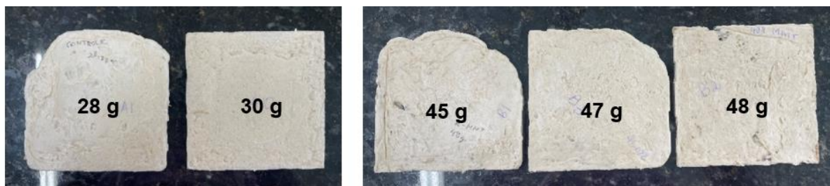
Figura 15 - Quantidades de massa adicionadas no molde para a produção das espumas (a) E-CONTROLE e (b) E-NaMt
