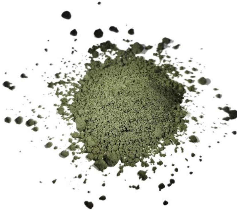
Figura 35: Pó metálico resultante da moagem de aço AISI H13.
