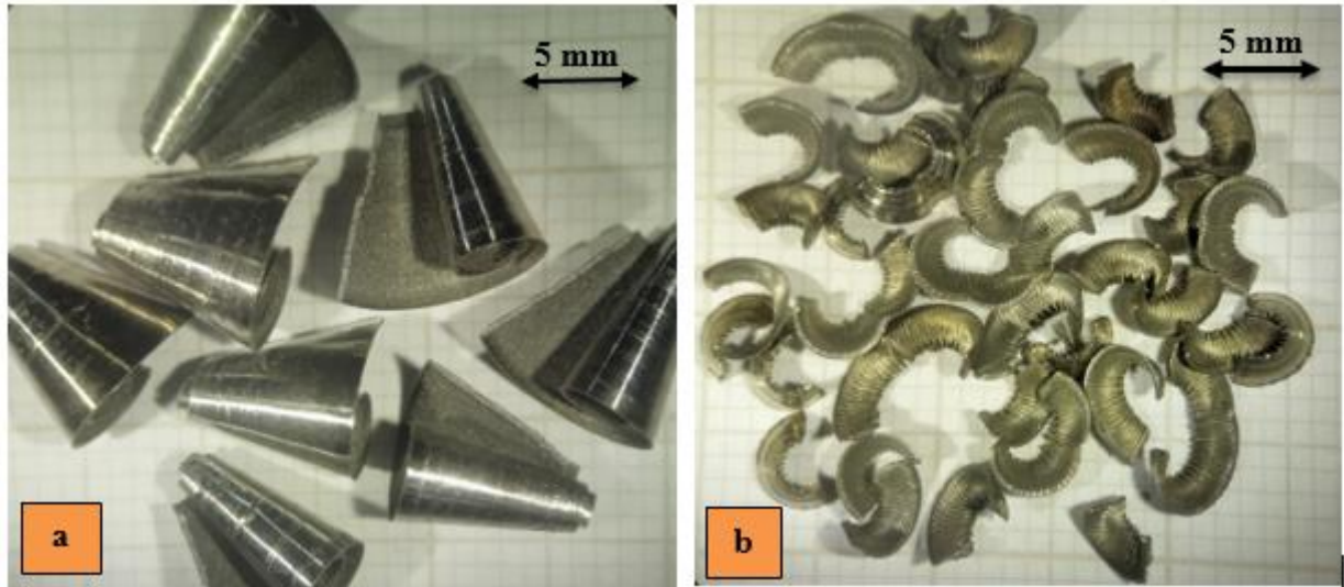
Figura 18: Resíduos de usinagem na forma de cavaco: Aço SAE 1045 (a); Aço AISI H13(b).
