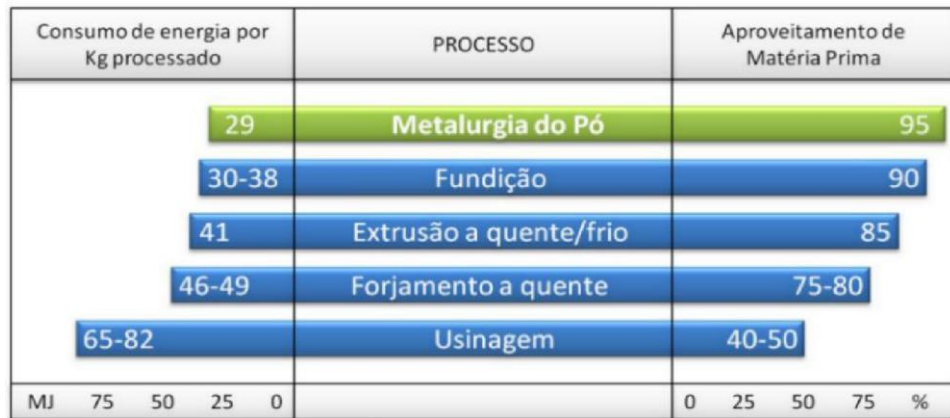
Figura 1: Comparação entre o consumo de energia e aproveitamento de matéria-prima obtidos para diferentes processos de fabricação.
