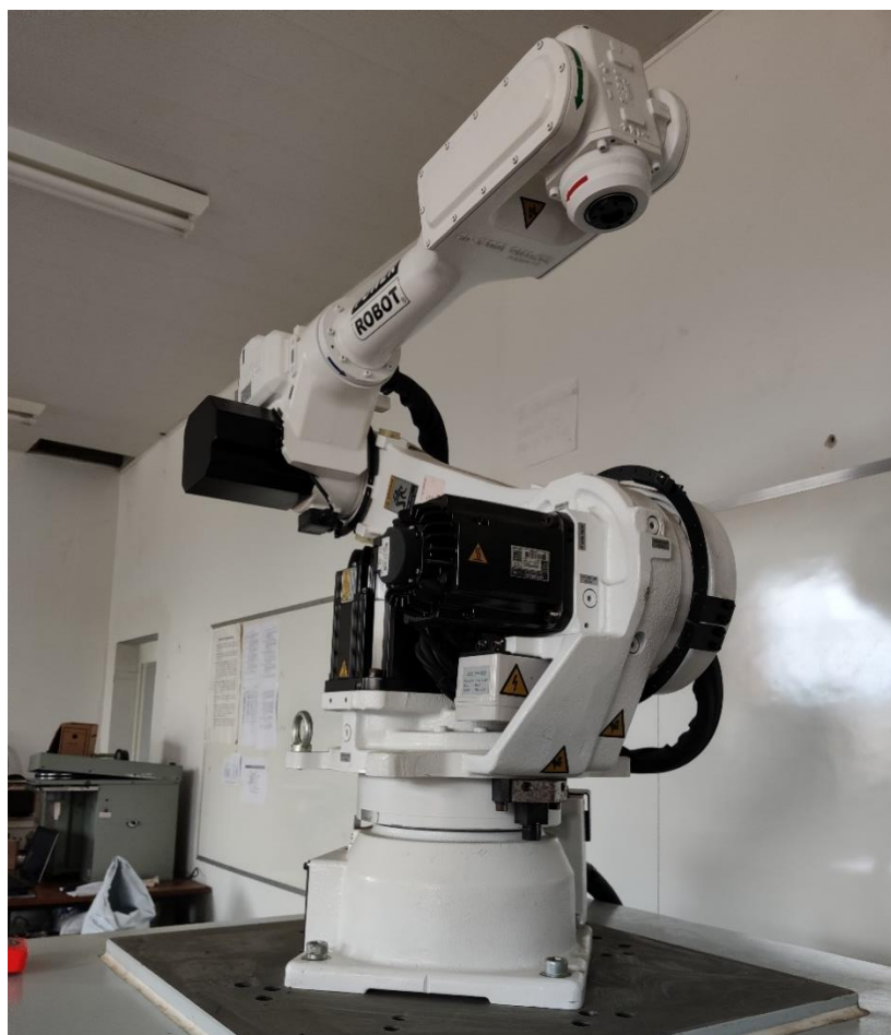
Figura 18 - Braço robótico utilizado na pesquisa para movimentação do tubo de deposição de argamassa
