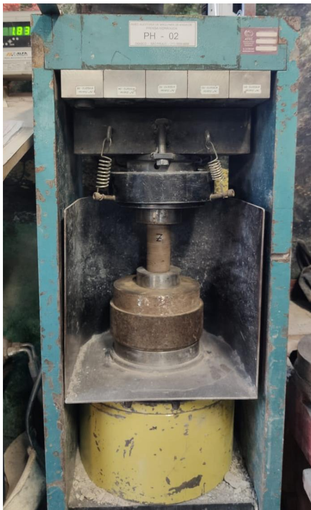
Figura 26 - Prensa hidráulica com corpo de prova para rompimento.
