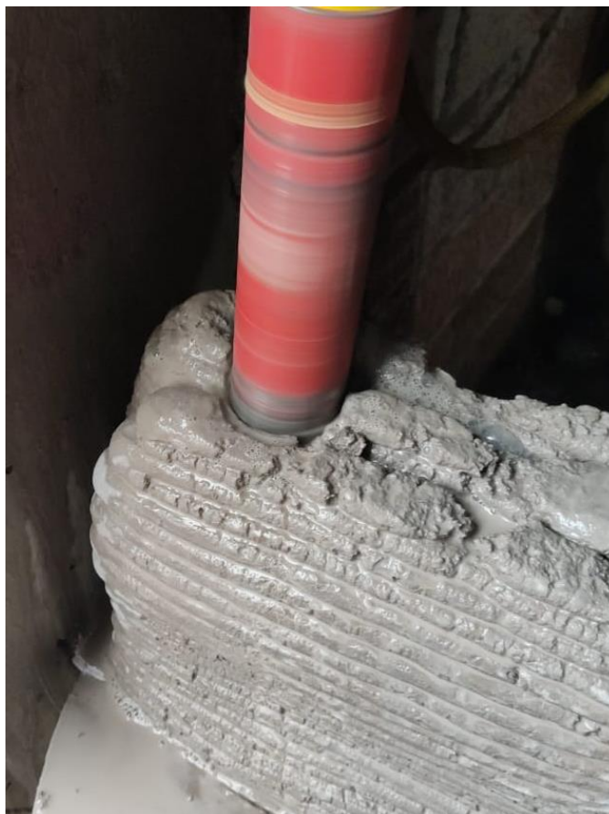
Figura 23 - Extração do Corpo de Prova na direção “z”.
