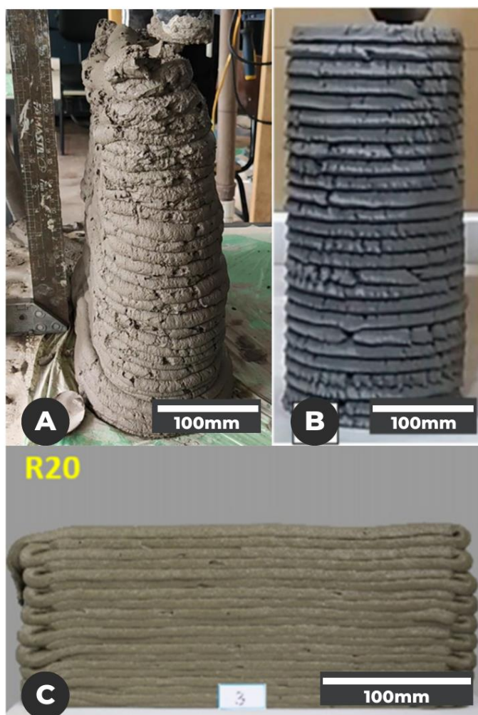
Figura 38 - Comparativo entre a amostra D45-38-30 (deste trabalho) (a), e resultados de Tay et al., 2019 (b) e Ma et al., 2018 (c).
