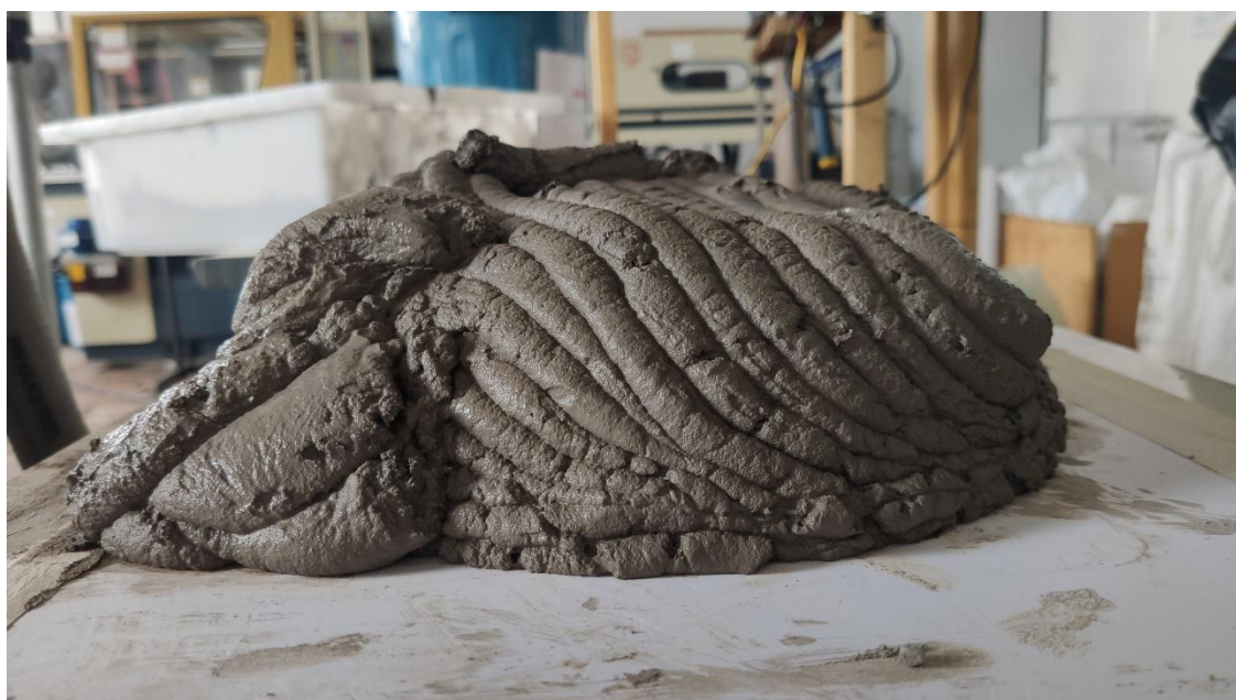
Figura 19 – Colapso prematuro da amostra por falta de resistência ao peso próprio
