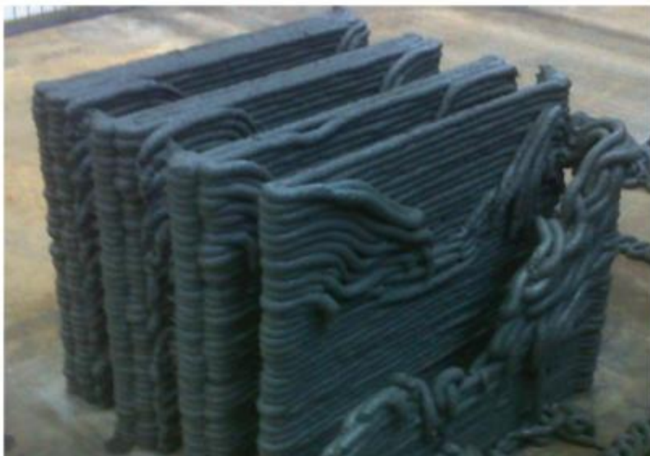
Figura 10 - Teste de buildability empírica para testar estabilidade vertical da composição da mistura ou dos parâmetros de impressão. Adaptado de Le et al.
