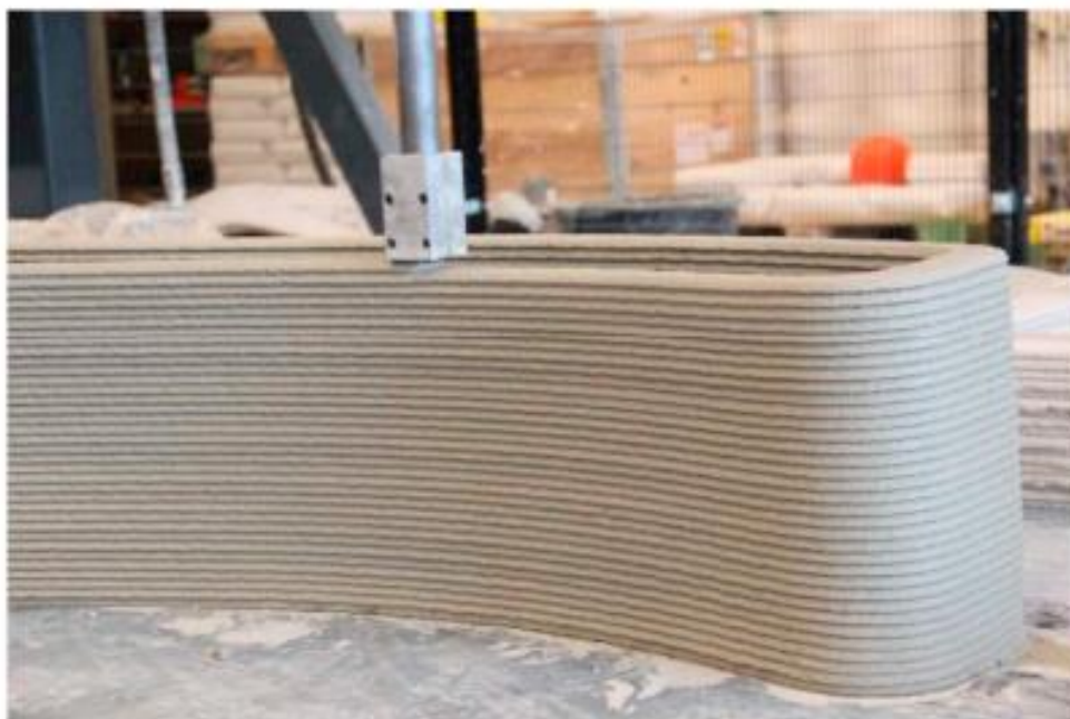
Figura 7 – Exemplo de teste de printability de argamassa. Adaptado de WOLFS et al. (2019)
