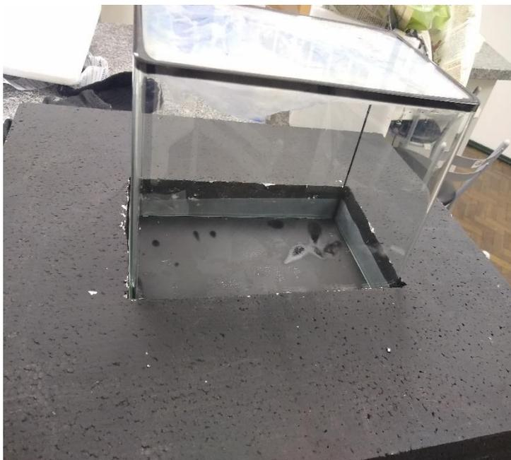
**Figura 20**– Nessa imagem a câmara de nuvens estava finalizada e pronta para o uso do experimento.
