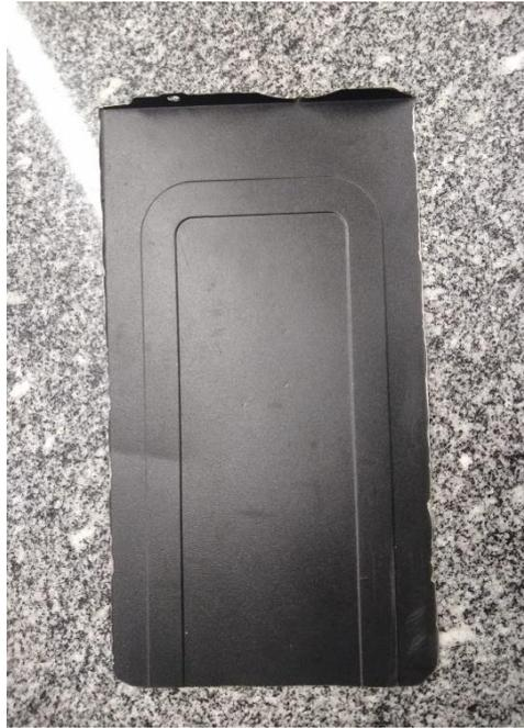
**Figura 16**–tampa de gabinete de computador entalhada manualmente, processo de falha no experimento.
