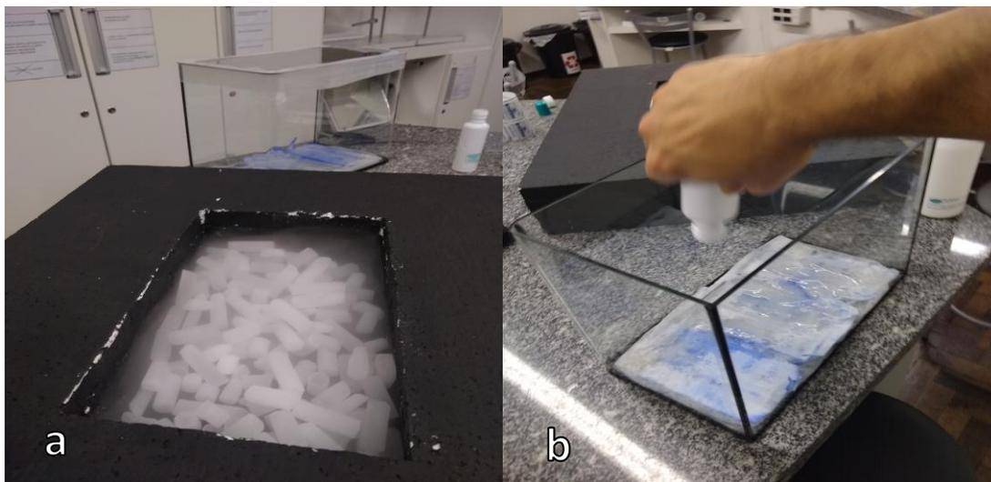
**Figura 18a, 18b**–Fenda preenchida com gelo seco no lado direito e no lado direito a colocação de álcool isopropílico sobre o feltro na câmara de acrílico.
